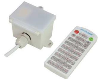
Les capteurs de la marque offrent de nombreux choix de signal de sortie : commande marche/arrêt, gradation à deux niveaux, gradation à trois niveaux, DALI et gradation en fonction de la lumière naturelle ambiante. Le capteur de luminosité offre la possibilité de définir un seuil de lumière naturelle ambiante au-dessus duquel le capteur est désactivé, de façon à diminuer la consommation d'énergie.
